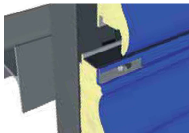
Montaggio dei pannelli in senso orizzontale (dal basso verso l'alto)
