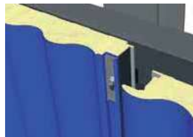
Montaggio dei pannelli in senso verticale
